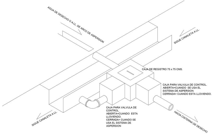
○ DETALLE DE FUNCIONAMIENTO DE CAJA DE REGISTRO
